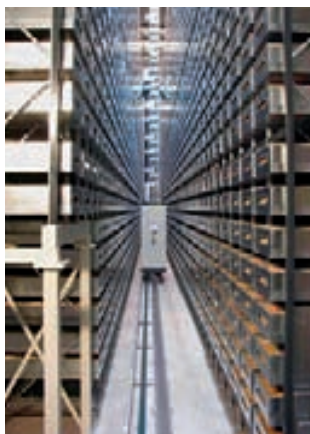
Das automatisierte Behälterlager der norwegischen Nationalbibliothek in Mo i Rana könnte für eine künftige schweizerische Speicherbibliothek als Modellanlage dienen.
